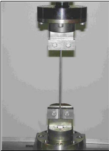
Εικόνα 4. Η τοποθέτηση του ήλου στο ειδικό μηχάνημα
